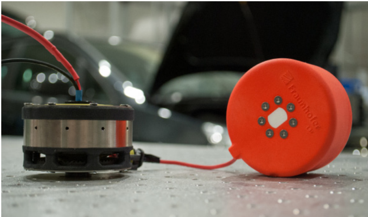
Abb. 1: Inertialmassenaktor zur Einleitung dynamischer Kräfte
