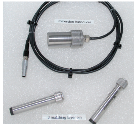
Tauchtchnik-Prüfkopf 5 MHz, wasserdicht bis 2 m.
