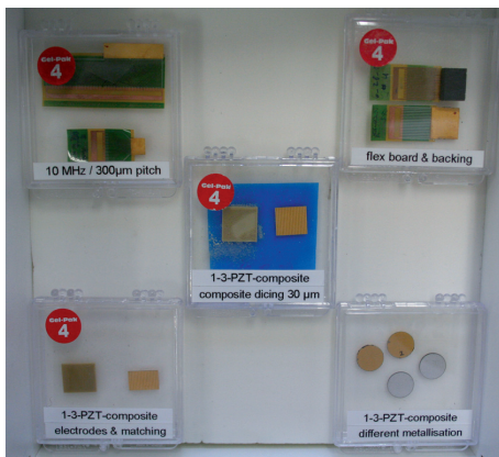
Fertigung von Phased-Array-Sensoren basierend auf 1-3-PZT-Kompositen.
