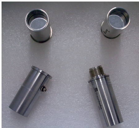
HF-Ultraschallprüfköpfe mit Aluminiumnitrid-Schwinger 150 MHz.
