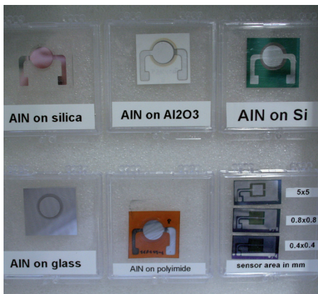
Schwinger aus Aluminiumnitrid auf verschiedenen Substratmaterialien und mit unterschiedlichen Elektrodengrößen.
