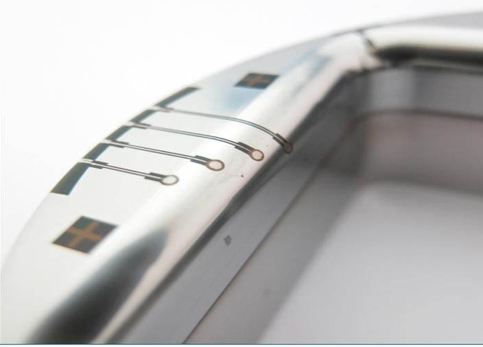
3 Tiefziehwerkzeug mit einzelnen Kraftsensorstrukturen auf der komplex geformten Oberfläche eines Tiefziehwerkzeuges.
